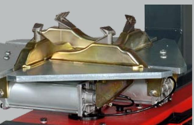
La particolare forma, le misure del palo e dello stallonatore rendono queste macchine particolarmente adatte ad operare con ruote di grandi dimensioni (dimensioni superiori a 15" di larghezza). Il cilindro stallonatore è a doppia azione ed ha una protezione interna in nylon.
