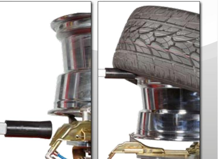
Braccio con rullo con possibilità di operare al di sotto del pneumatico.
