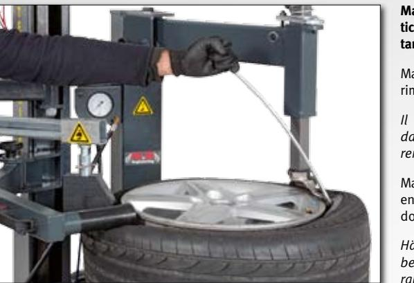
Mantiene il tallone del pneumatico nel canale del cerchio facilitando l'estrazione.
